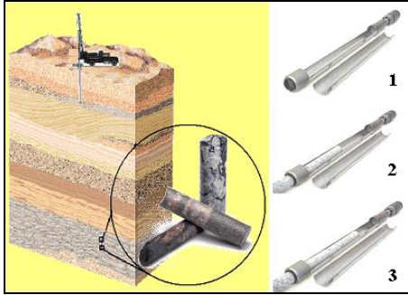
Karotlu sondajın genel modeli
