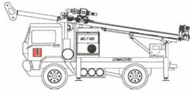
Kamyon monte, döner kafalı sondaj makinası
