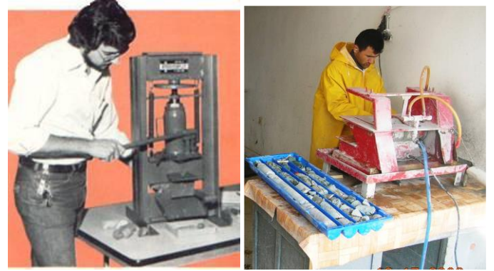
Karot yarılama aletleri ve işlemin yapılışı
