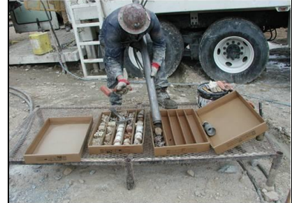
Karotun karotiyerden çıkartılması ve karot sandığına yerleştirilmesi
