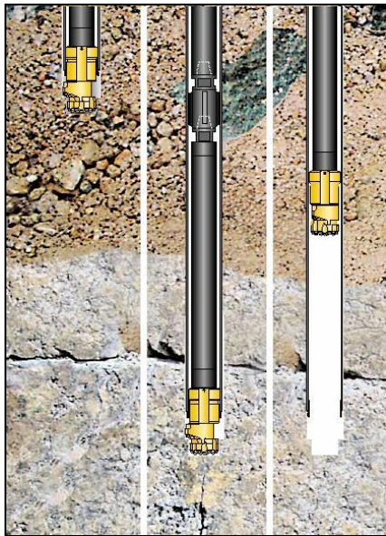
Odex sondaj yöntemi işlem basamakları
